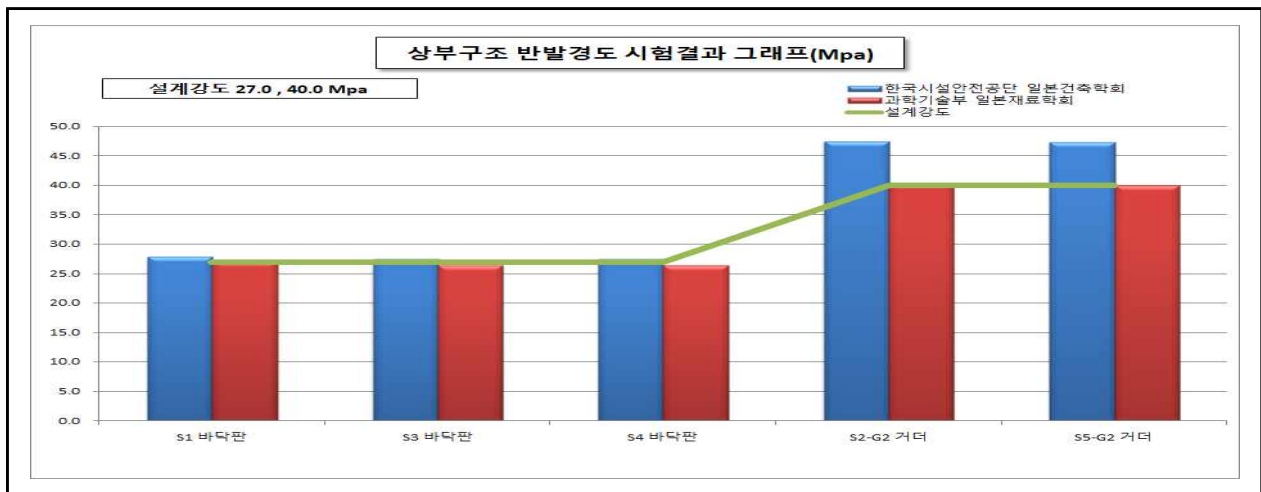
【그림 3.4.5】 영천방향 상부구조 반발경도시험 측정결과
